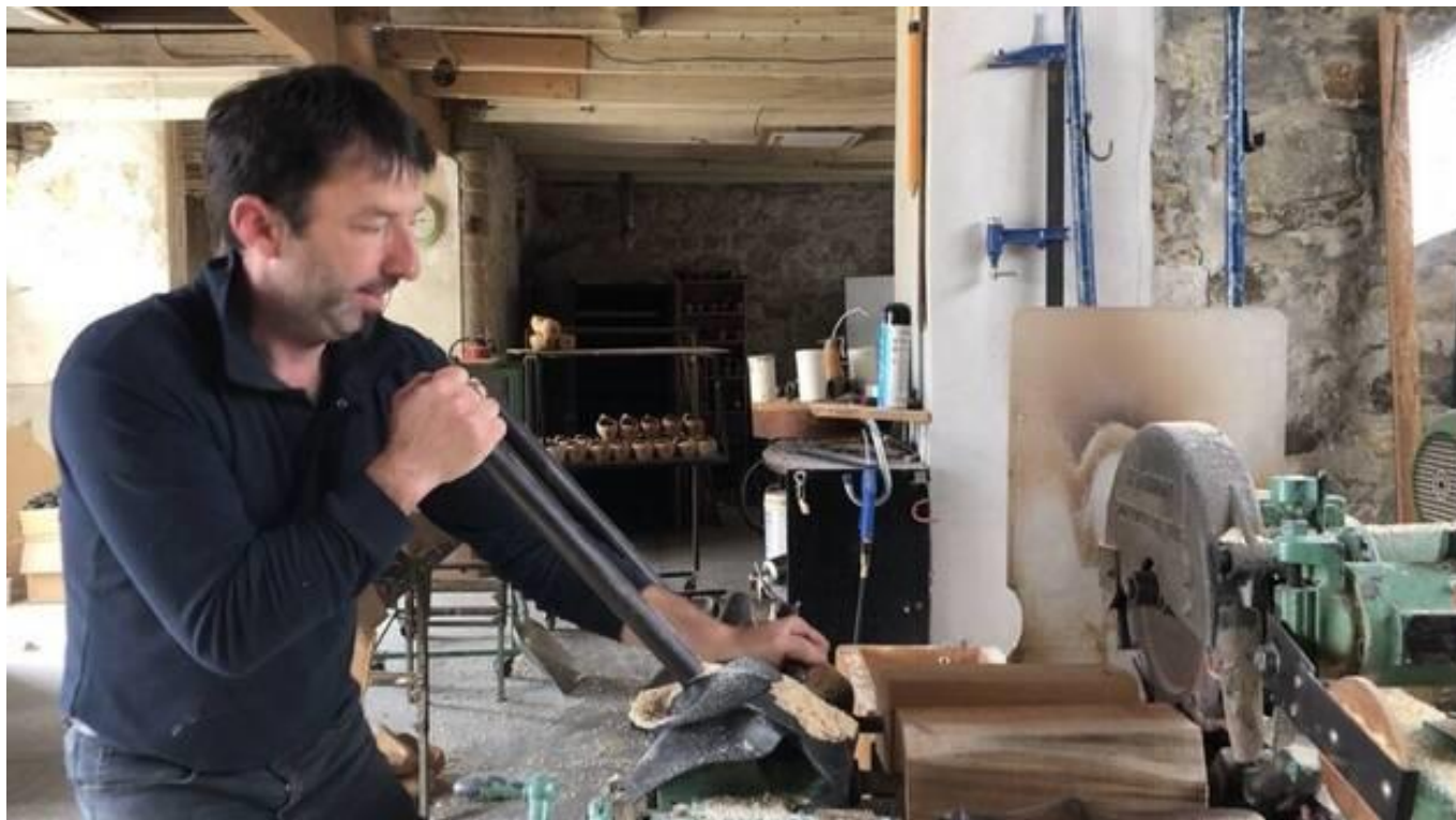
L'une des premières étapes de fabrication d'un sabot, dans un pantographe pour découper les rectangles de bois et leur donner la forme si particulière de cette chaussure.
